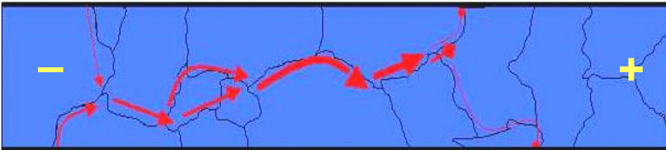
електроміграція (локальне перегрівання)
