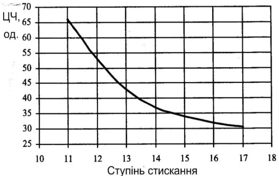
Рис. 1.21. Залежність цетанового числа від ступеня стискання двигуна.
