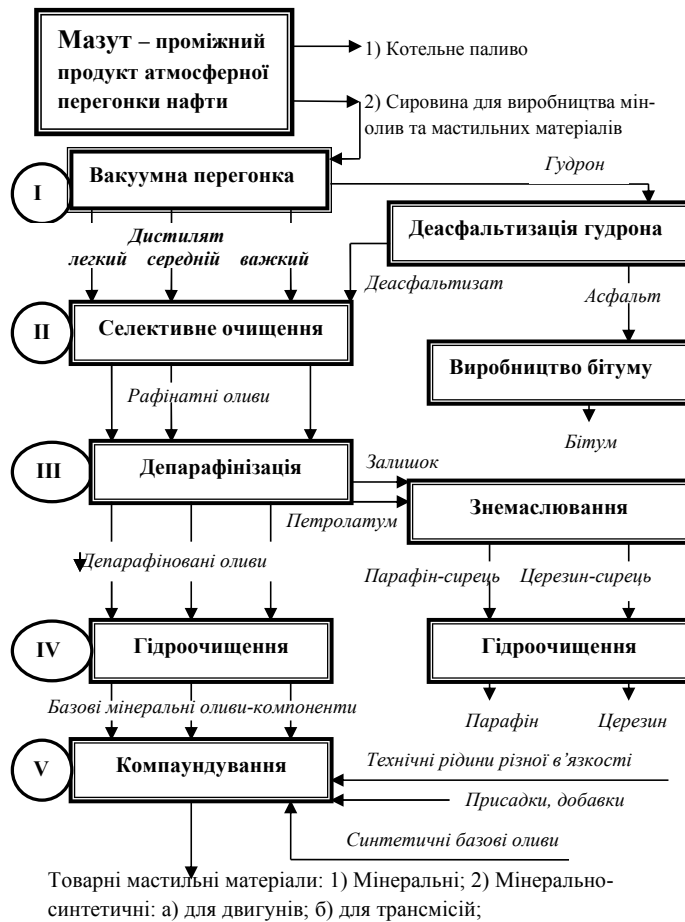
Рис. 1.2. Схема процесів і технологій перероблення мазуту на базові мінеральні оливи та товарні мастильні композиції.
