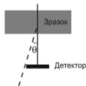
Рис. 2.9. Геометрія системи для детектування електронів.
