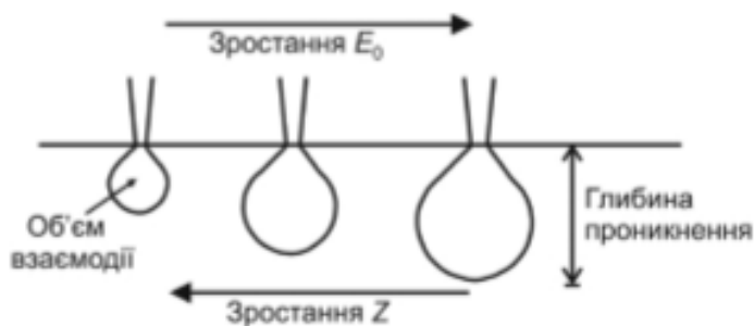
Рис. 2.8. Схематична залежність об'єму взаємодії та глибини проникнення первинних електронів як функція їхньої енергії E_0 та атомного номера зразка Z .
