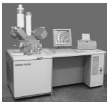
Рис. 5.1. Сканувальний електронний мікроскоп-мікроаналізатор РЕММА 102-02 (BAT SELMI, м. Суми).
