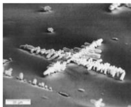
Рис. 5.2. Мікрофотографія поверхні сплаву нікелю, що містить дендритні (деревоподібні) частинки кремнію, отримана СЕМ.
