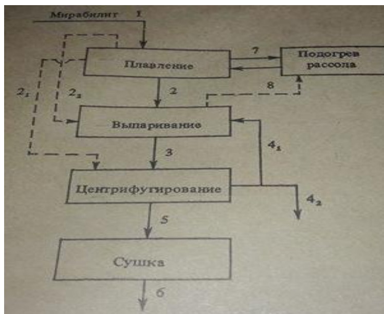
Рис.1. Схема переробки мірабіліту способом плавлення - випарювання. Основний процес позначений суцільними лініями.
