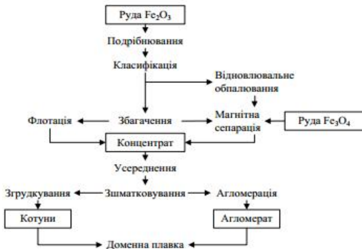
Рис. 9.4. Принципова схема підготовки залізних руд до доменної плавки
