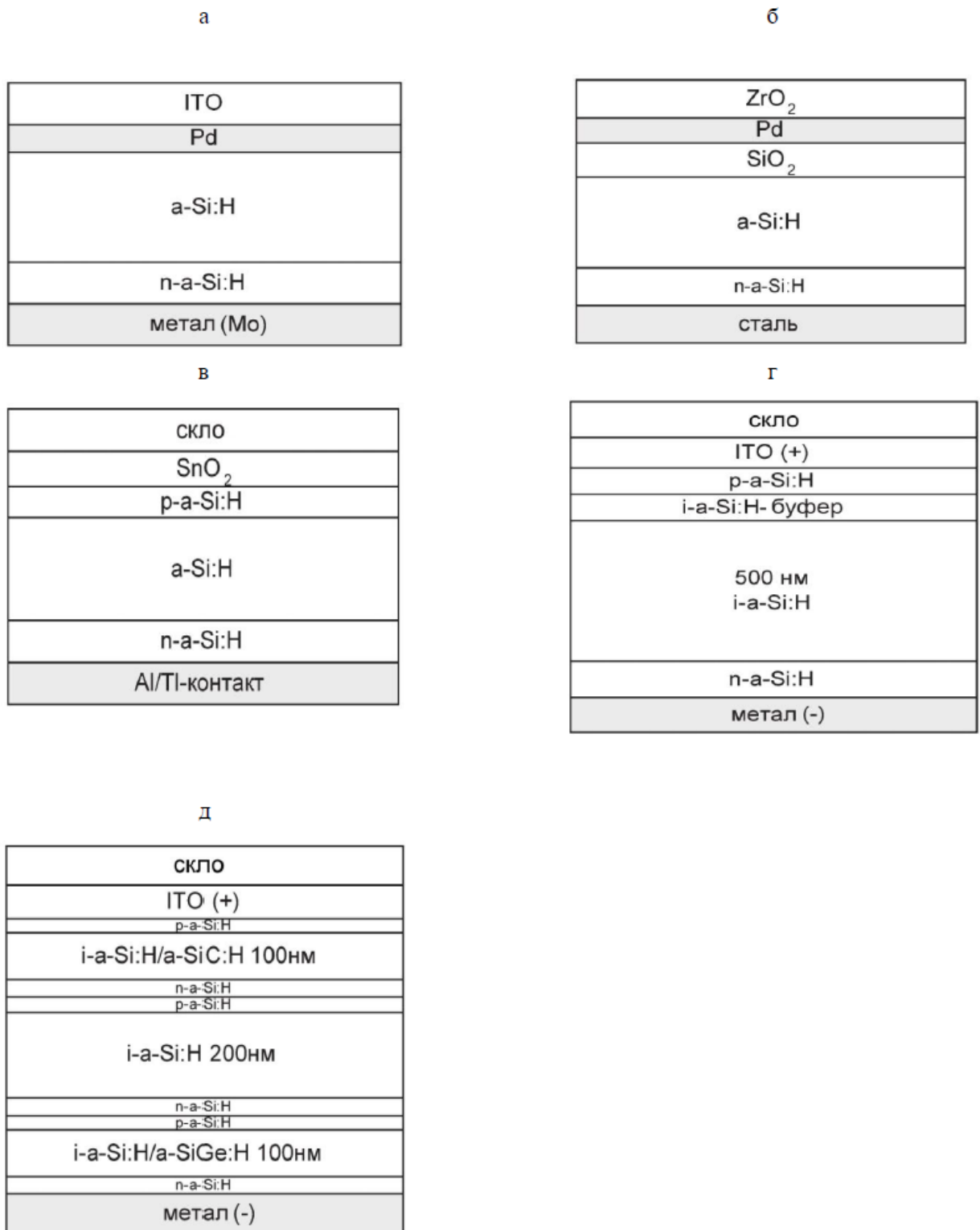
Рис. 7 - СЕ на основі аморфного кремнію: а) бар'єр Шоттки б) МДП (MUS) – структура; в) і-п-структура; г) і-п-структура з буферним шаром (одноперехідний елемент); д) трьохперехідний елемент (3 р-і-п-структури з послідовним з'єднанням)
