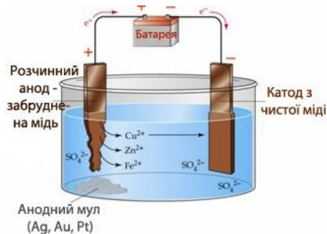
Рис. 5. Схема електрохімічного способу рафінування міді
