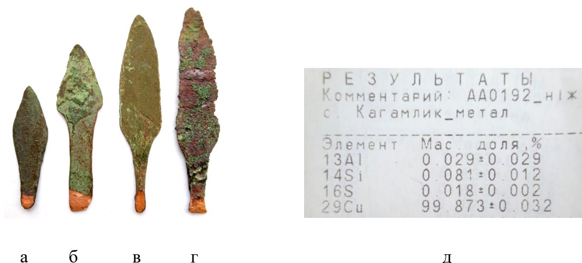
Рис. 1. Зображення мідних ножів (а-г), виготовлених із самородного металу ( V тис. до н. е.) та елементний склад міді (д). Знайдені в с. Кирдани Київської обл. (а), довжина ножа 49 мм; с. Кагамлик Полтавської обл. (б); м. Велика Богачка Полтавської обл. (в); с. Городниця Івано-Франківської обл. (г)
