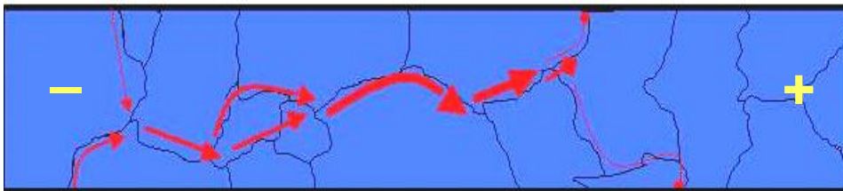
електроміграція (локальне перегрівання)
