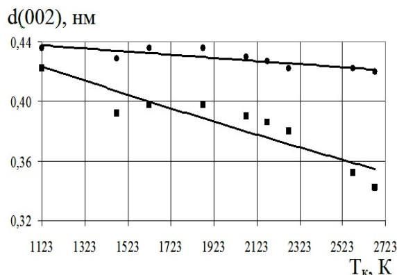
Рис. 3.14. Залежність міжшарової відстані для вуглецевого волокна ТГН-Т після 200 год. хемо-механічної активації у кульовому млинку від кінцевої температури теплової обробки T_k (ТТО): ● – вихідне волокно; ■ – після 200 год. обробки у КМ.
