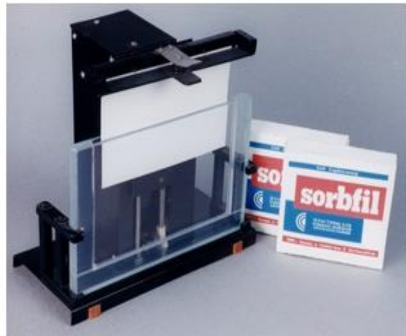
Прилад для обробки пластин рідиною для проявлення методом занурення
