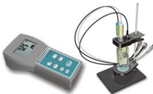
Рис. 1. рН метр 150: 1 - перетворювач, 2 – штатив з електродами; 3- стакан з досліджуваним розчином, в якому занурені електроди.
