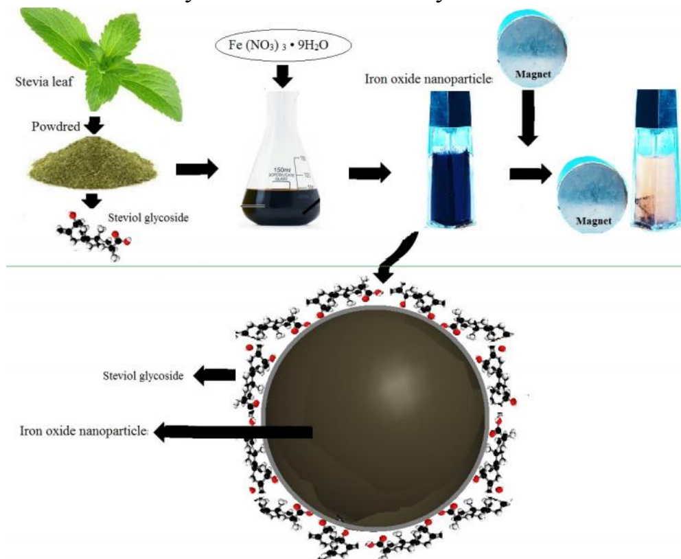
Рис. 11. Схема «зеленого синтезу магнітних наночастинок [10].
