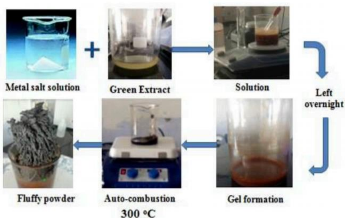
Рис. 12. Схема «зеленого» синтезу Ag-допованих наночастинок \text{CoFe}_2\text{O}_4 [8].
