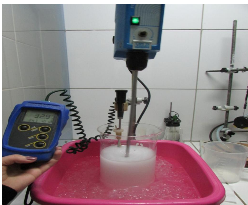
Рис.4. Установка для охолодження смоли
