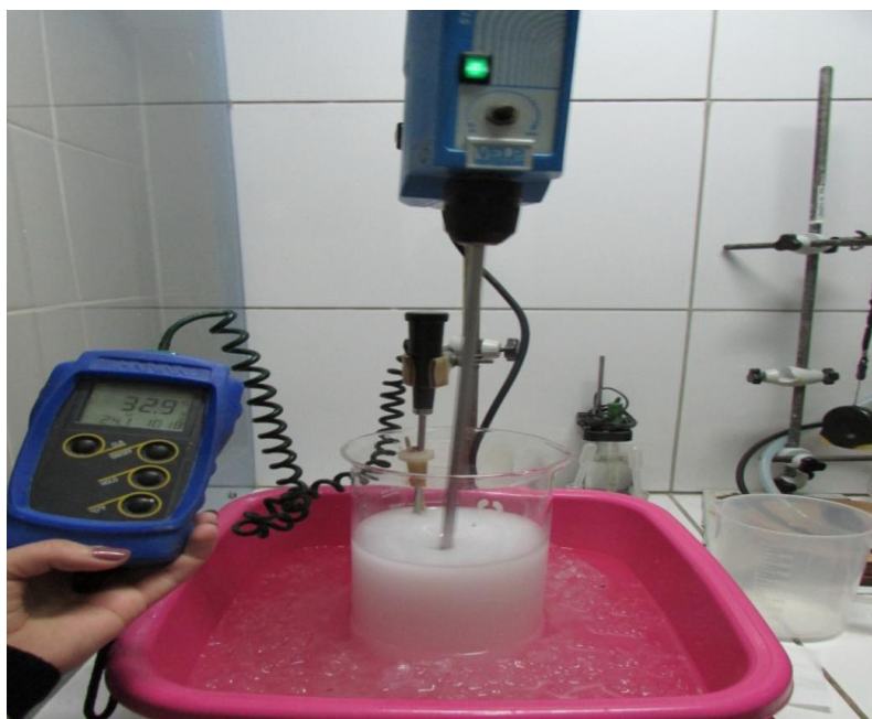
Рис.4. Установка для охолодження смоли
