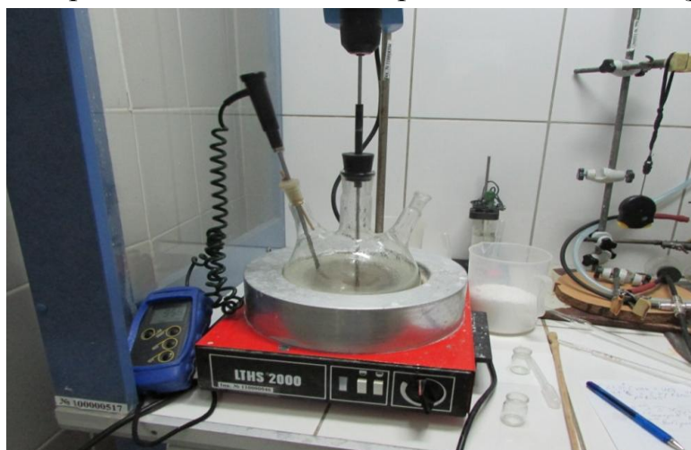
Рис.3. Установка для синтезу КФС з використанням \text{HCOOH}
