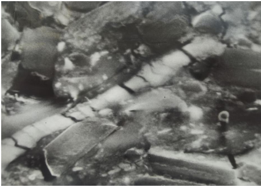
Рис. 1.29. Електронна мікросвітлина ( \times 2150 ) поверхні тертя зразка твердої колоїдної системи флубон ДМ-1 на основі політетрафлуоретилену та 25% двокомпонентної дисперсної фази [15% карбонізованого ( T_k = 1123 К) вуглецевого волокна (ГЦ; LM) + 10% порошку MoS_2 ]. Умови випробувань: схема контакту «на півсфера-площина» зразок флубон ДМ-1 – сталь 45 (НВ = 4,2 ГПа; Ra_0 = 0,09 мкм); N_i = 100 Н; v = 0,8 м/с; T = 373 К; S = 18 км.
