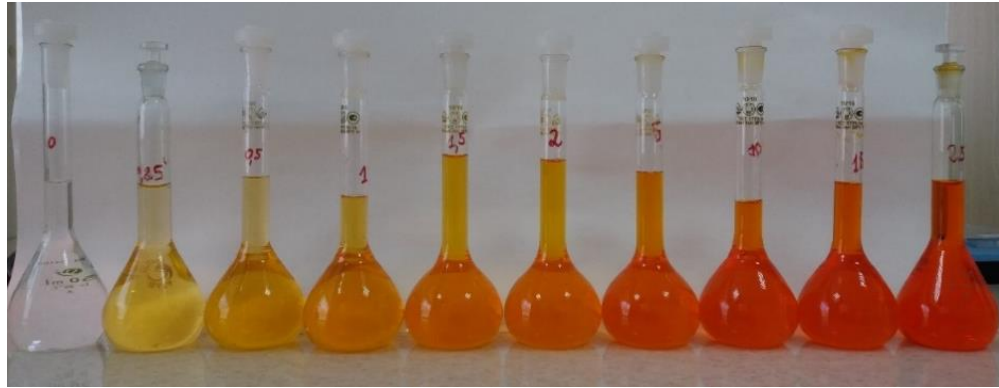
Рис. 3. Серія стандартних розчинів аніонного барвника метилоранжу для калібрувального графіка та залежність оптичної густини їх розчинів від довжини хвилі (кювета на 5 мм).
