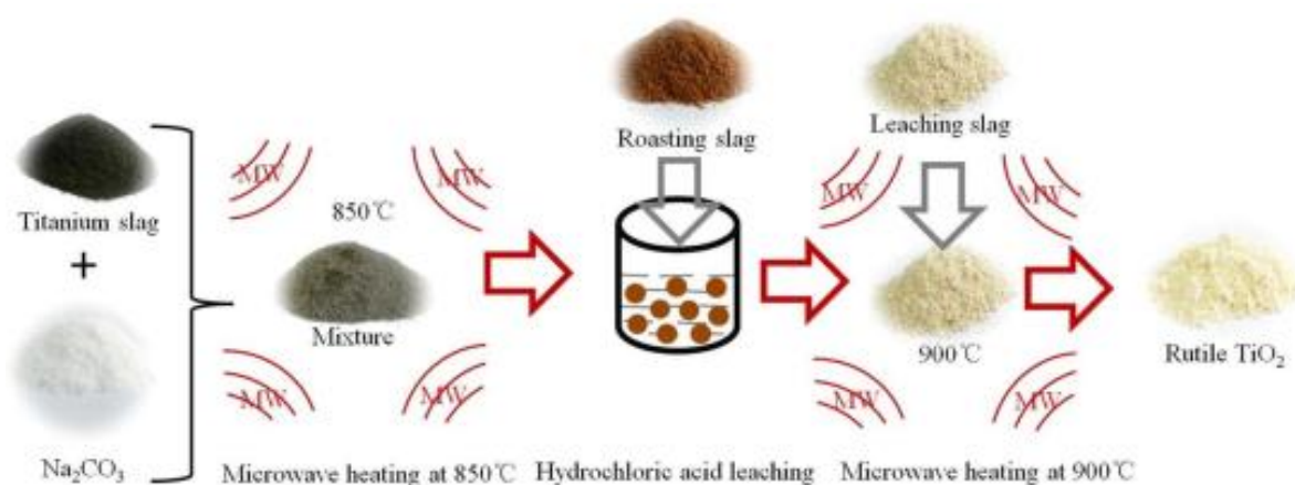
Рис. 3. Схема мікрохвильового синтезу рутилу діоксиду титану
