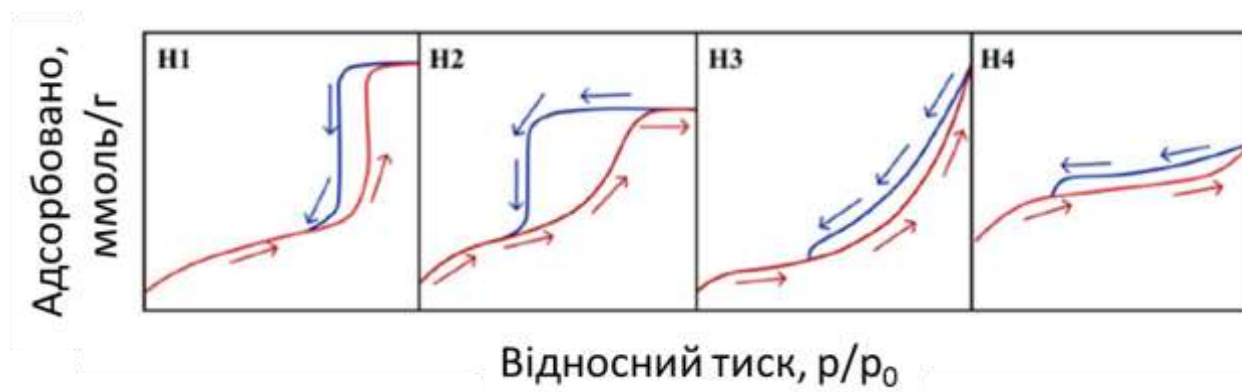
Рис. 1.5. Класифікація гістерезису адсорбції згідно з IUPAC (червона крива – хід адсорбції; синя крива – хід десорбції)
