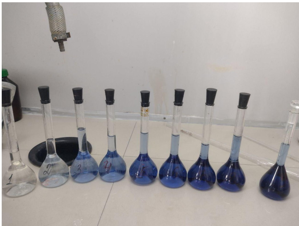
Рис. 2.10. Зовнішній вигляд розчинів, що використовують для побудови
