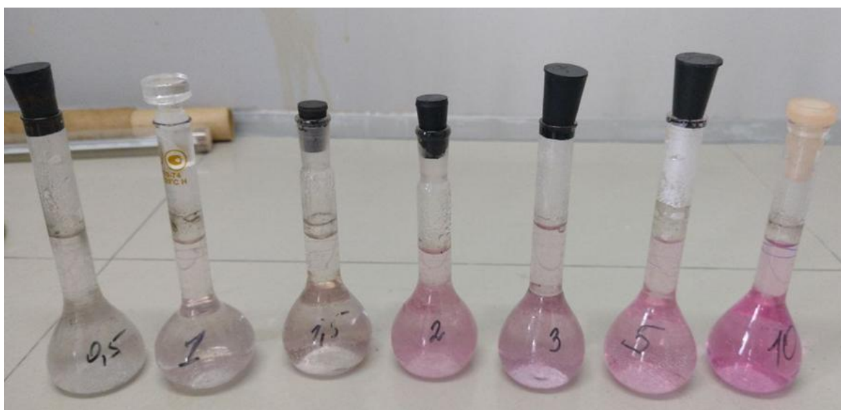
Рис. 2.13. Зовнішній вигляд розчинів, що використовують для побудови калібрувального графік (нітрити)
