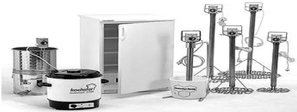
Рис.3.3. Промислове обладнання для розпуску закристалізованого меду до рідкого стану класичним методом нагрівання теплопередачею з довготривалим електропідігрівом або у водяній сорочці при 70-80°C, і перемішуванням на протязі 8-12год при 50-60°C.
