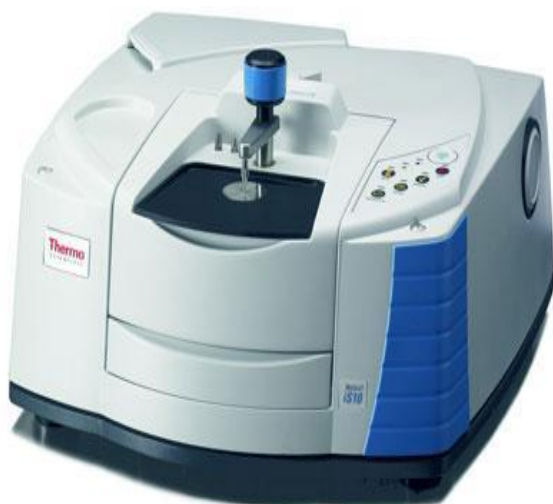
Рис.2.3. FTIR spektrometer Nicolet iS50, який працює в діапазоні 380\text{-}12500\text{ см}^{-1} , на автоматичному трансмісійному(KBr) або відбитому модулях АТР, з використанням лазера 1064\text{ см}^{-1} , для аналізу рідких та твердих зразків.
