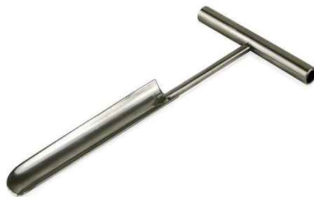
Рис. 16. Щуп для відбору проб сиру
