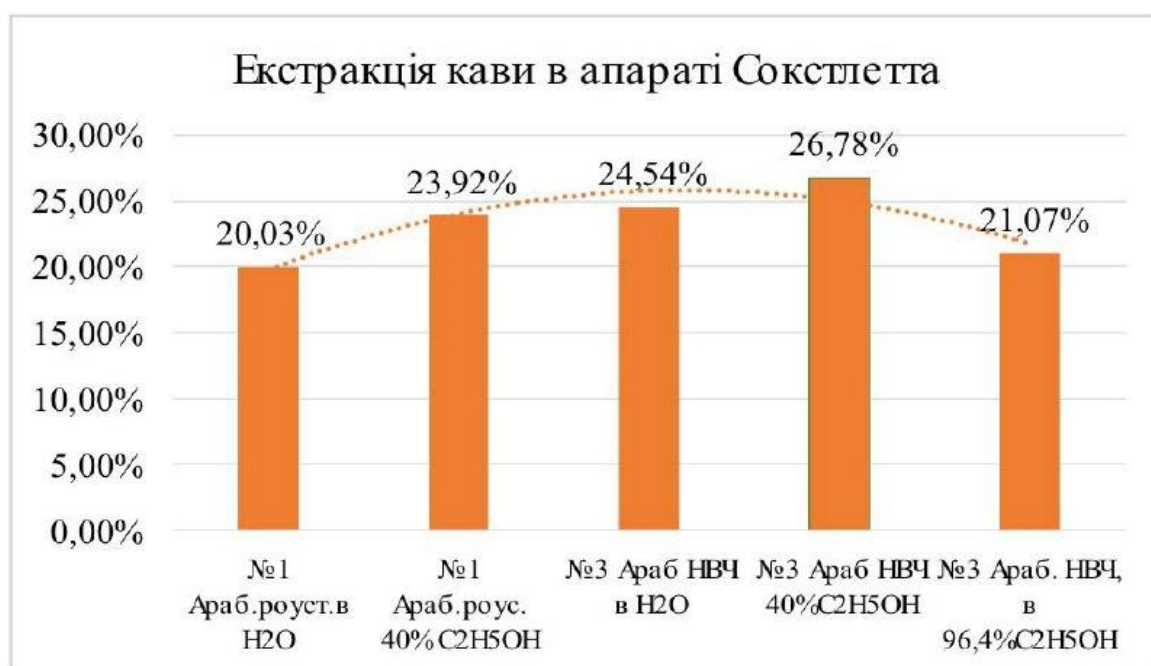
Рис. 3.11 Гістограми відображають залежність ефективності екстракції кави від способу термообсмажування — у ростері або мікрохвильовій печі, а також від виду екстрагента — водного або винного розчину.
