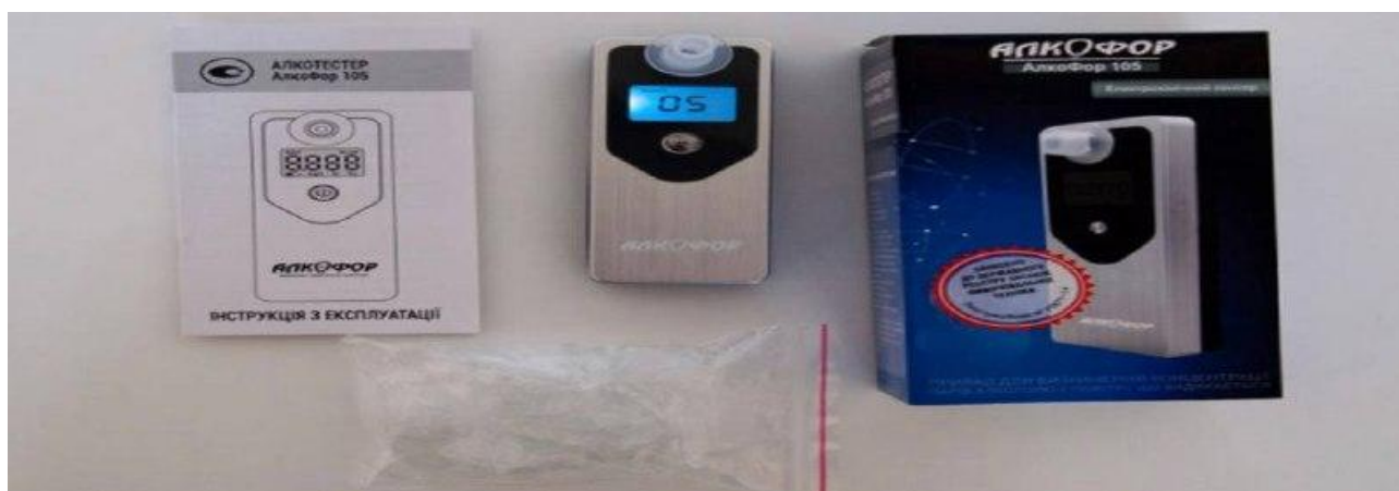
Рис.3.16 Алкофор-105 — пристрій для вимірювання вмісту парів винного спирту в пробах видихуваного повітря
