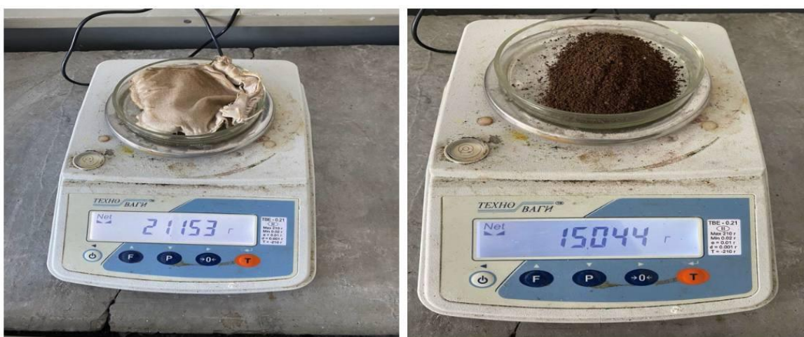
Рис. 3.10 Зважування подрібненої кави після витяжки з апарату Сокстлетта на визначення безводного залишку у воді та абсолютному спирті
