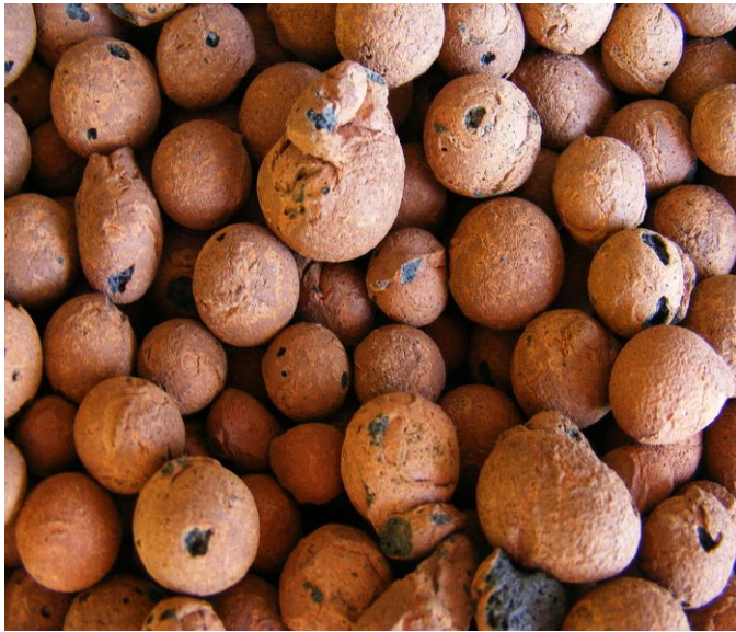
Рис.1.7. Керамзит (від грец. кέραμος — «глина») [17] —штучний пористий заповнювач, тепло- і звукоізолятор.
